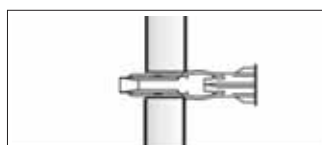
Разожмите и вставьте OLA в отверстие до упора.
