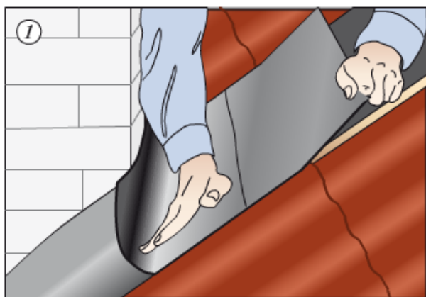
Загнуть ленту на трубу и приклеить
