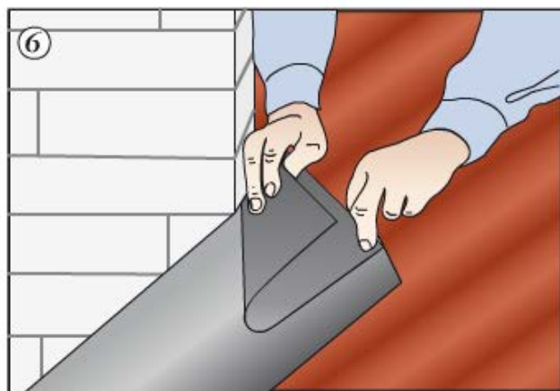
6 Дополнительно проклеить верхние углы обрезками ленты
