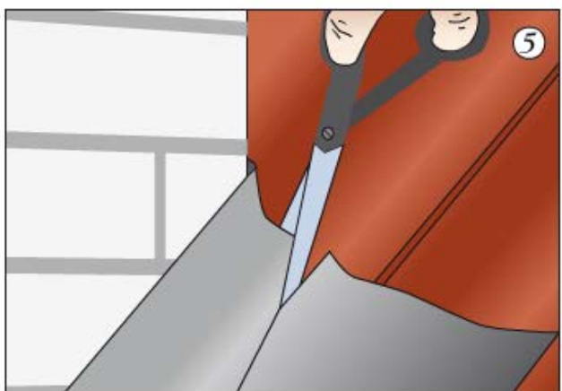
5 Надрезать и загнуть ленту на верхней части трубы
