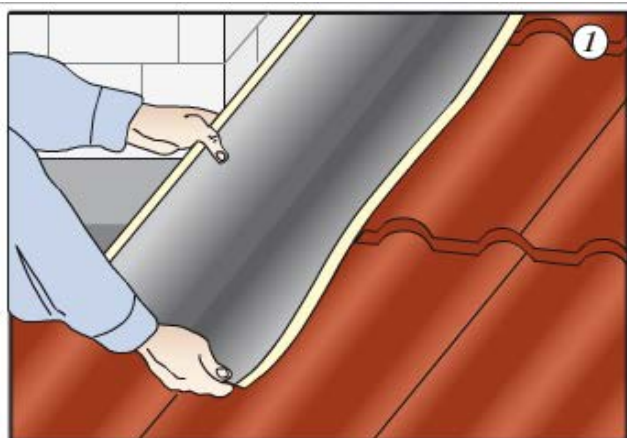
1 Отмерить, отрезать полосу Вакафлекса и приклеить к боковой поверхности трубы, аналогично работам на рис. 2
