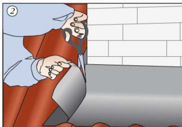
2 Надрезать верхнюю часть ленты в нижнем углу трубы
