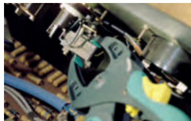
с длинными, острыми лапками зажима, оптимальное использование для зажатия в узких проемах
