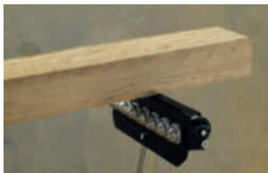
прочное основание служит в качестве удлинителя рабочего стола и в качестве опоры для длинных обрабатываемых деталей
