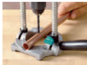
V-образный паз для фиксации круглых деталей
