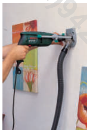
с подключением отсоса пыли
