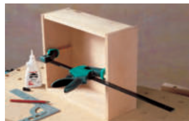
просто выполняемое переоборудование для функции распора
