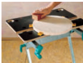
зажима из пластика для плоских деталей
