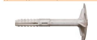
Дюбель для теплоизоляции IZO - полипропиленовый распорный дюбель для крепления в бетон, кирпич плит из минеральной ваты и пенопласта с пластмассовым гвоздем.
