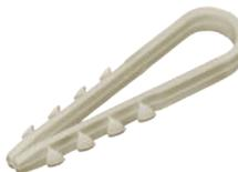
Используется для крепления кабелей (проводов), пучков кабелей (проводов), металло-рукова и гофро-рукова к бетону и сплошной кирпичу. Обеспечивает лёгкость и быстроту монтажа, надёжность и прочность крепления. Позволяет исключить из процесса монтажных работ дюбеля и шурупы.
