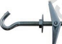
Изготовлен из стали с гальваническим цинковым покрытием, винт с крюком - стальной с гальваническим цинковым покрытием и метрической резьбой. Применяется для крепления легких конструкций к гипсокартонным плитам и другим пустотелым конструкциям.
