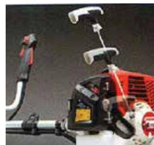
Комфорт. Крышка воздушного фильтра снимается без инструмента
