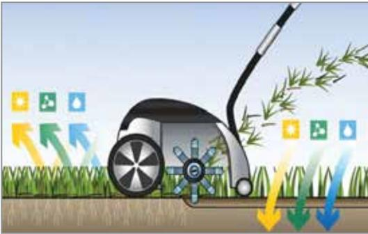
Скарификатор - это устройство, при помощи которого осуществляется аэрация верхнего слоя почвы. Дело в том, что корневая система у травы со временем становится гуще и плотнее. После процедуры аэрации газон получит больше воздуха, больше воды и питательных веществ. Они будут лучше доходить до корневой системы и быстрее впитываться. Аэрацию газона рекомендуется производить один раз в две-три недели.
